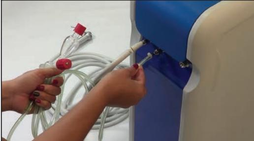
*Connecter le cordon à acide hyaluronique au raccord de diffusion à un bout et au diffuseur qOartz à l'autre bout.*
