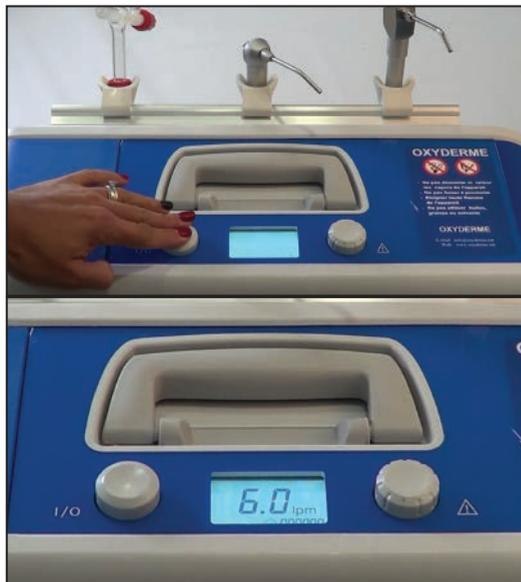
Pour mettre l'appareil en service, enclencher l'interrupteur principal (1) qui se trouve sur la partie supérieure.
